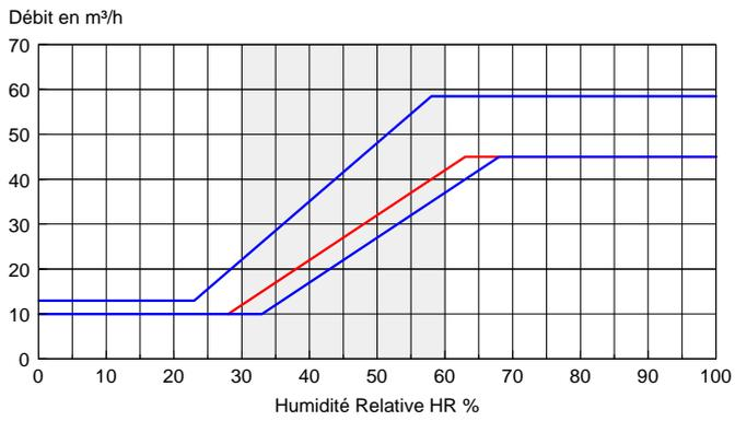
**Figure 18e – Caractéristiques hygroaérauliques des bouches d'extraction hygroréglables pour une différence de pression de 80 Pa, modèle BEHS/W.DP 10-45/45, 28-63%HR**
